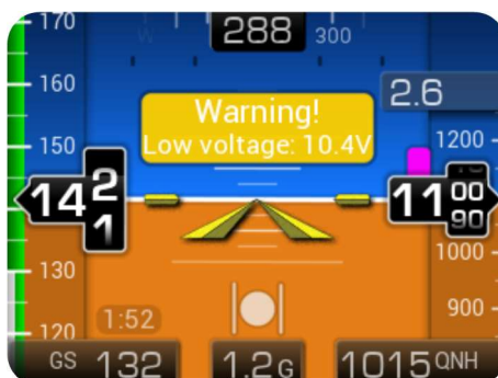
Obr. 25 – varování před podpětím
