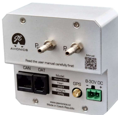
Obr. 8 – Detail zadní strany přístroje verze Master s hadicovými trny, napájecím konektorem, GPS konektorem a konektory pro OAT čidlo a CAN-Bus
