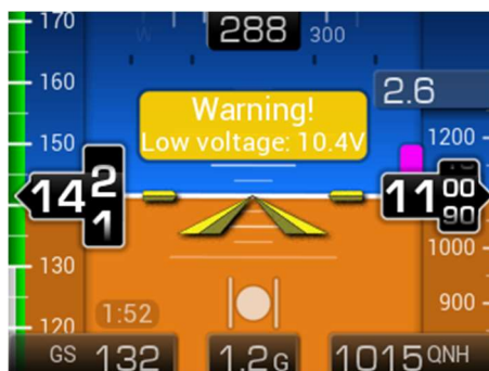
Obr. 21 – varování před podpětím
