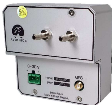
Obr. 5 – Detail zadní strany přístroje s hadicovými trny, napájecím a GPS konektorem
