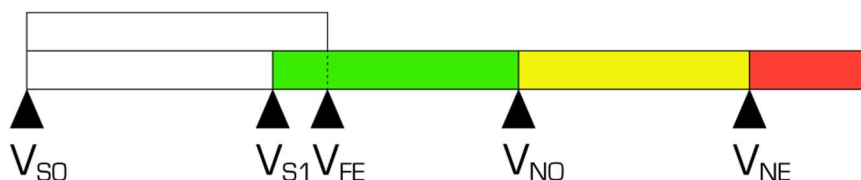
Obr. 16 – rozložení pásu barevného označení rychlostí
