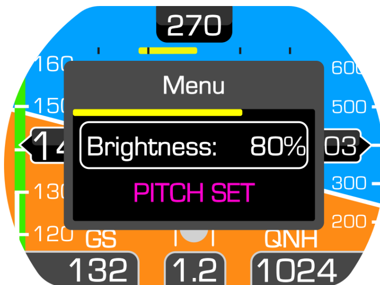
Obr. 7 – PFD submenu s volbou vynulování klonění prostřednictvím „PITCH RESET“
